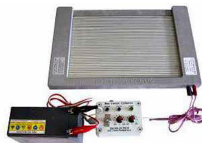
Slika naprave za pridobivanje čebeljega strupa Vir: Čebelarska zveza Slovenije.
