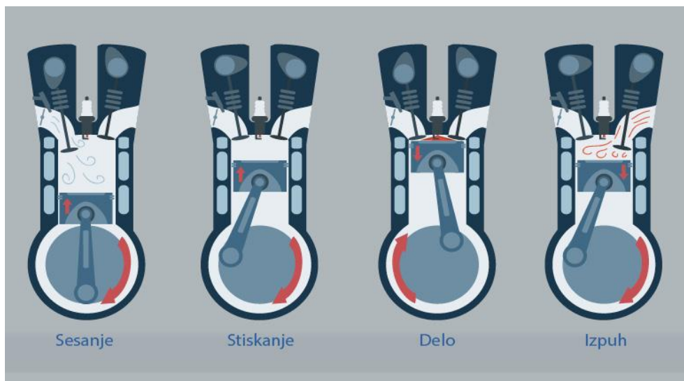
Slika 7: Princip delovanja štiriktaktnega motorja (7)
